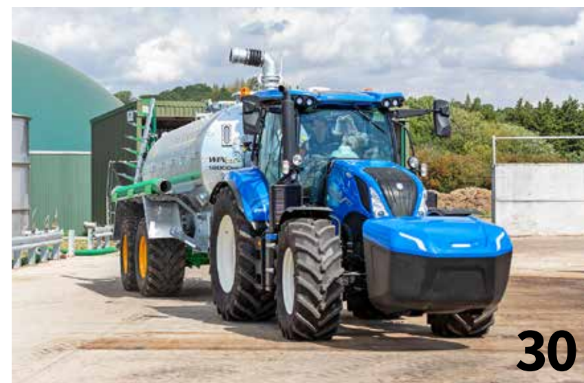
Maatalous on hyvin ajan hermolla vihreässä siirtymässä. Tästä yhtenä esimerkkinä on ensimmäinen markkinoille tullut suoraan biokaasua hyödyntävä sarjavalmisteinen traktori.
